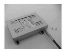
6. 内蔵HDDのHDDブラケットを元の場所に取り付けます。
